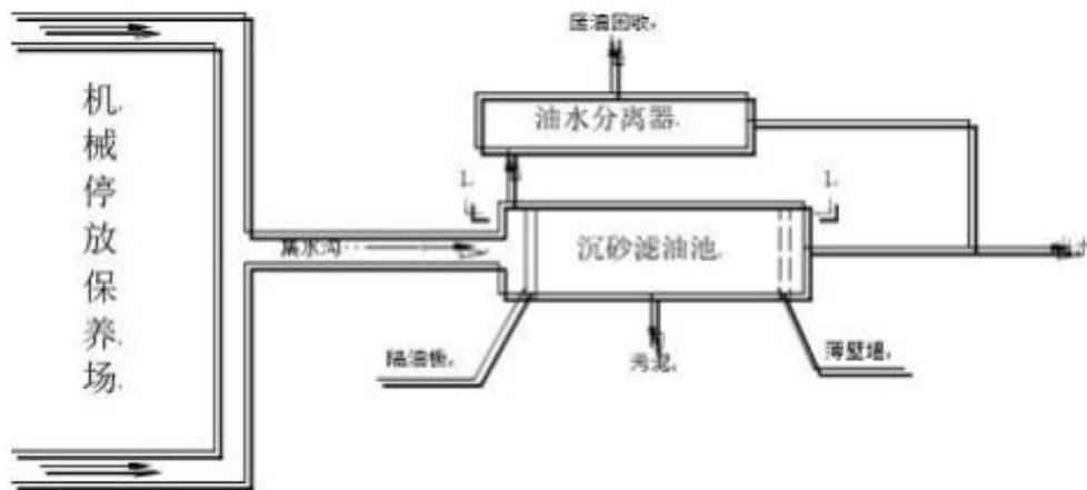
图 7.1-1 车辆和机械冲洗废水工艺流程
