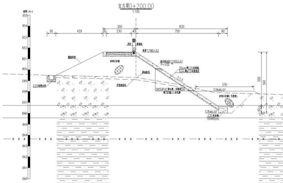
图 3.2.2-1 斜坡堤横断面图
