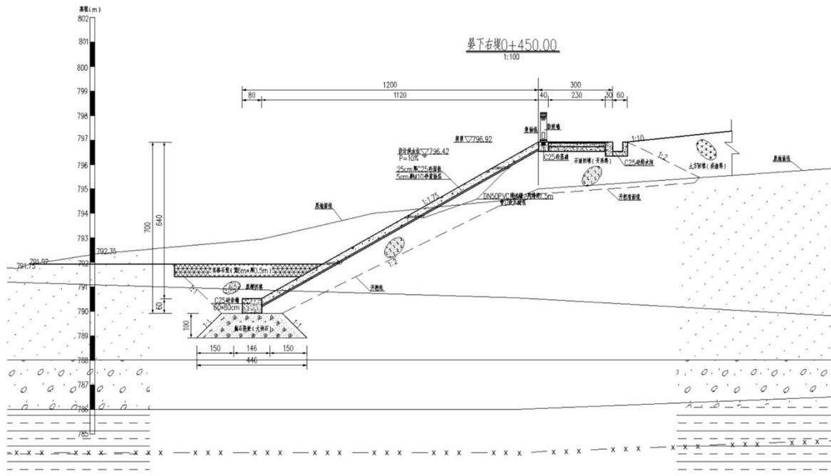
图 3.2.2-3 斜坡堤横断面图
