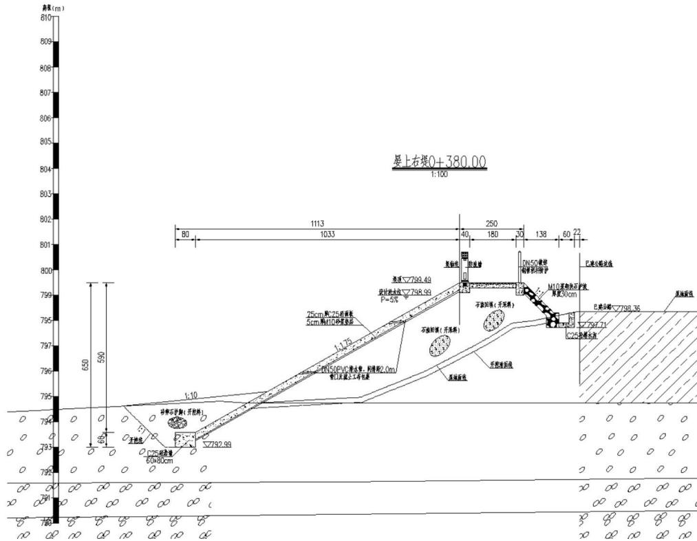
图 3.2.2-2 斜坡堤横断面图
